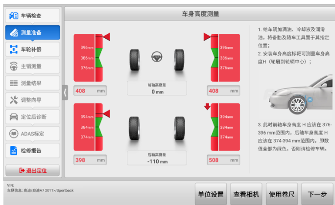
图 4-33 用车身高度标靶测量车身高度
