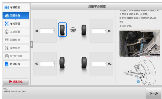
图 4-34 测量并输入倾斜角度
